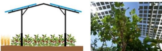
aufgeständerte AgriPV Anlagen zum geschützten Anbau von Obst und Gemüse mit Doppelglas Modulen in verschiedenen Transparenzgraden
